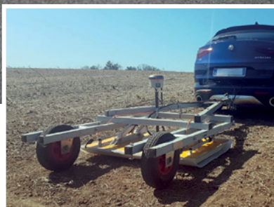
Mappatura 3D di sottoservizi e del sottosuolo
