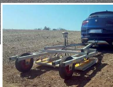
**Mappatura 3D di sottoservizi e del sottosuolo**
