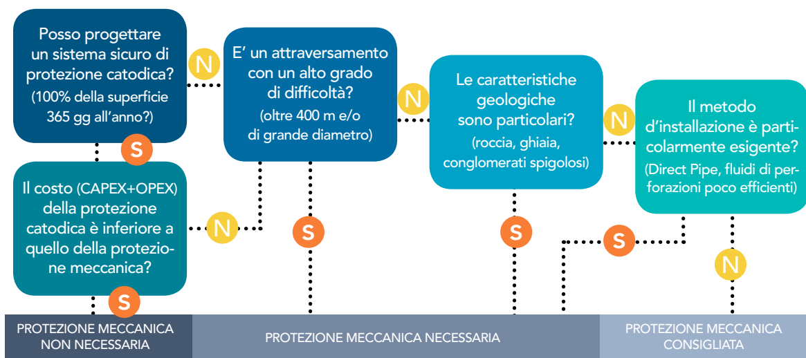
Fig. 1 – Albero decisionale per la selezione della protezione meccanica in attraversamenti trenchless
