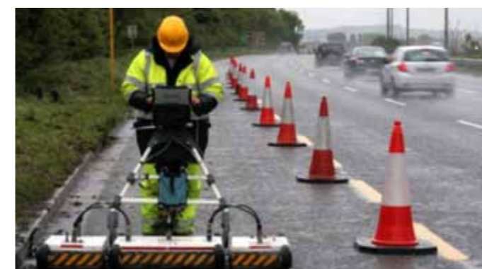
Fig.1 - Applicazione del georadar a doppia frequenza per indagini conoscitive del sottosuolo ed individuazione di sottoservizi
